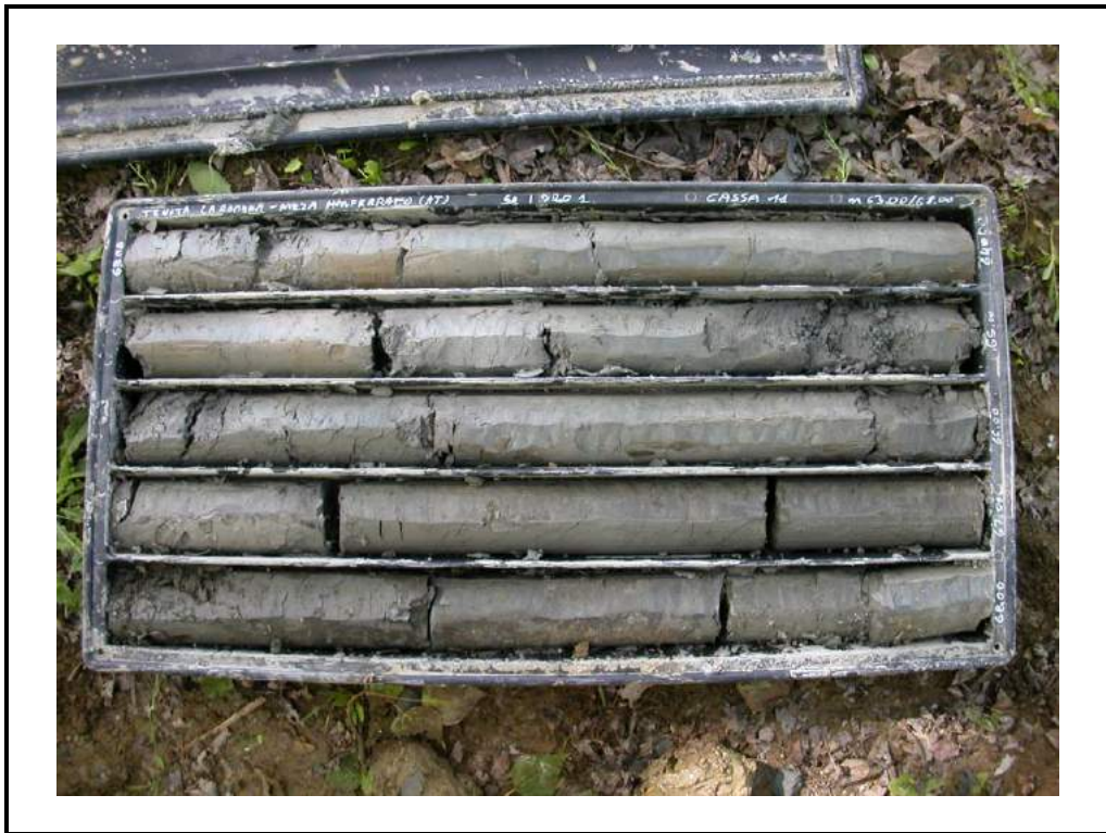
Foto 11: Sondaggio 1 - cassa 11 - da 63.00 m a 68.00 m.
