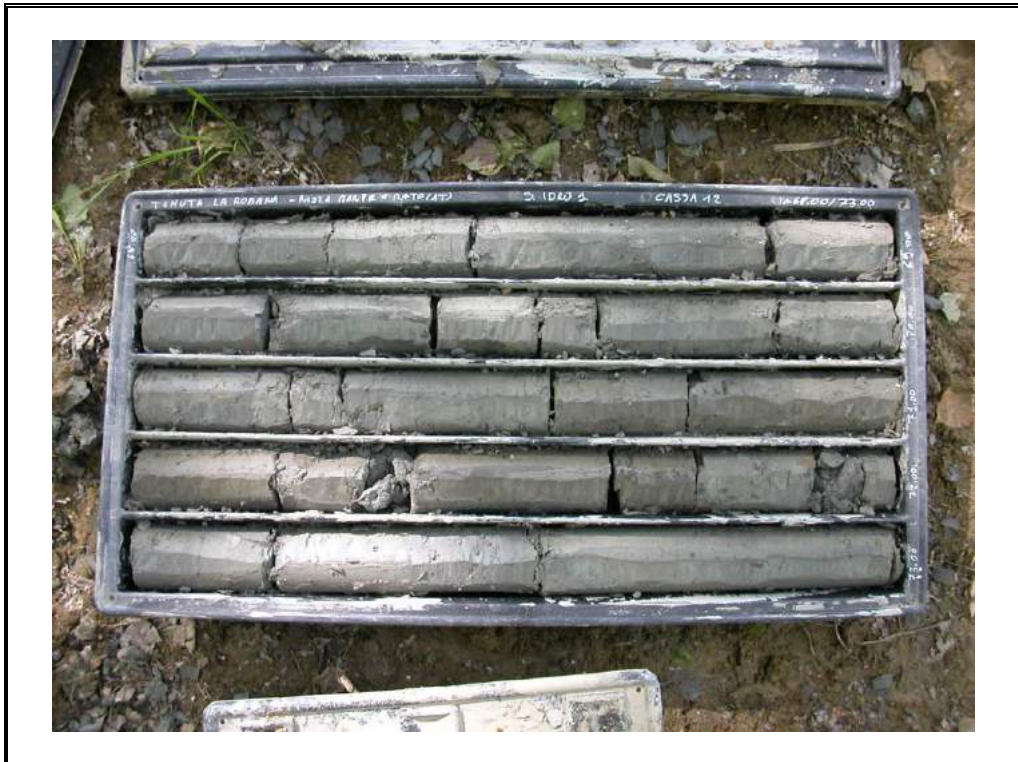
Foto 12: Sondaggio 1 - cassa 12 - da 68.00 m a 73.00 m.
