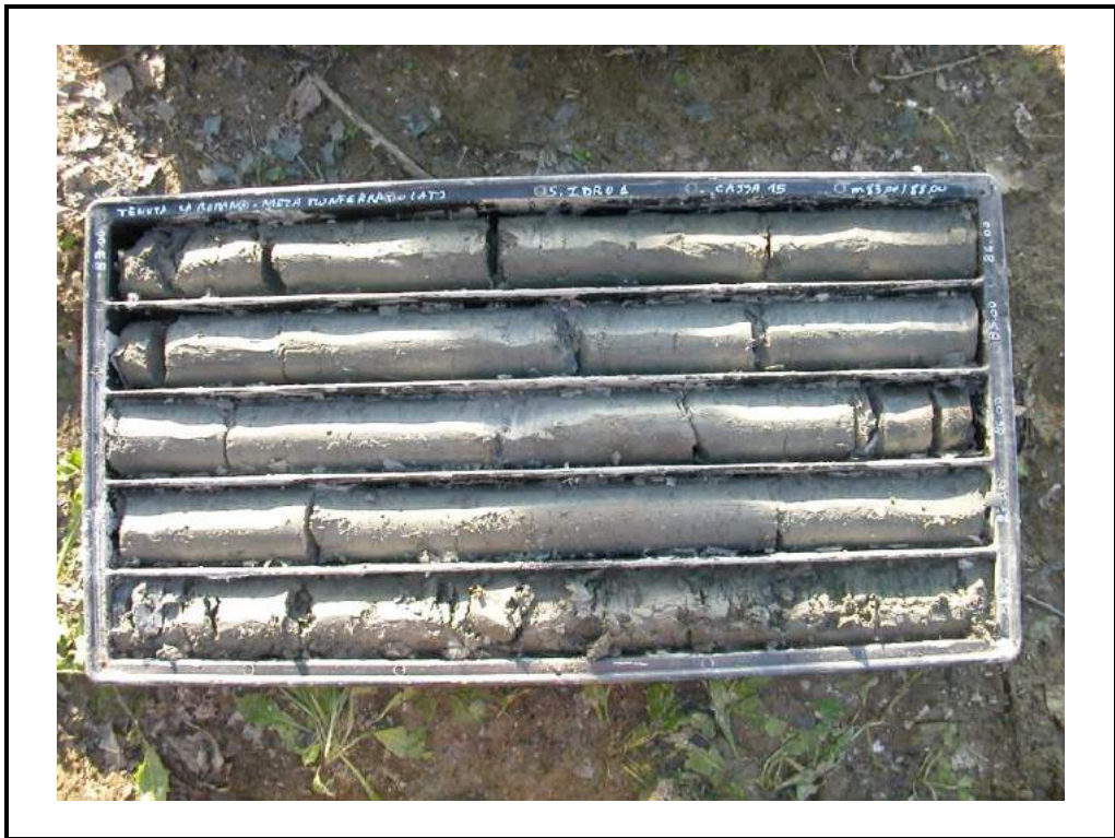
Foto 15: Sondaggio 1 - cassa 15 - da 83.00 m a 88.00 m.
