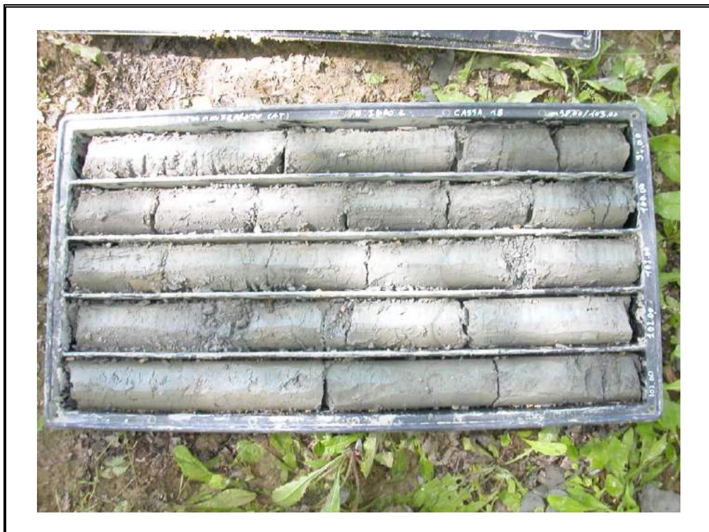
Foto 18: Sondaggio 1 - cassa 18 - da 98.00 m a 103.00 m.
