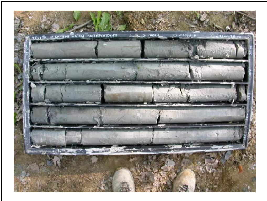
Foto 5: Sondaggio 1 - cassa 5 - da 33.00 m a 38.00 m.
