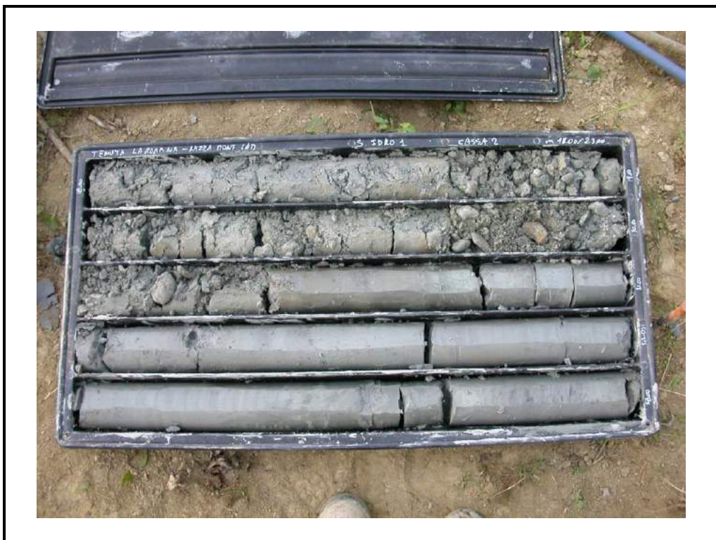
Foto 2: Sondaggio 1 - cassa 2 - da 18.00 m a 23.00 m.
