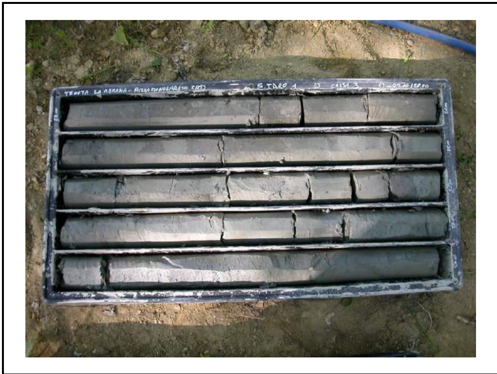
Foto 3: Sondaggio 1 - cassa 3 - da 23.00 m a 28.00 m.
