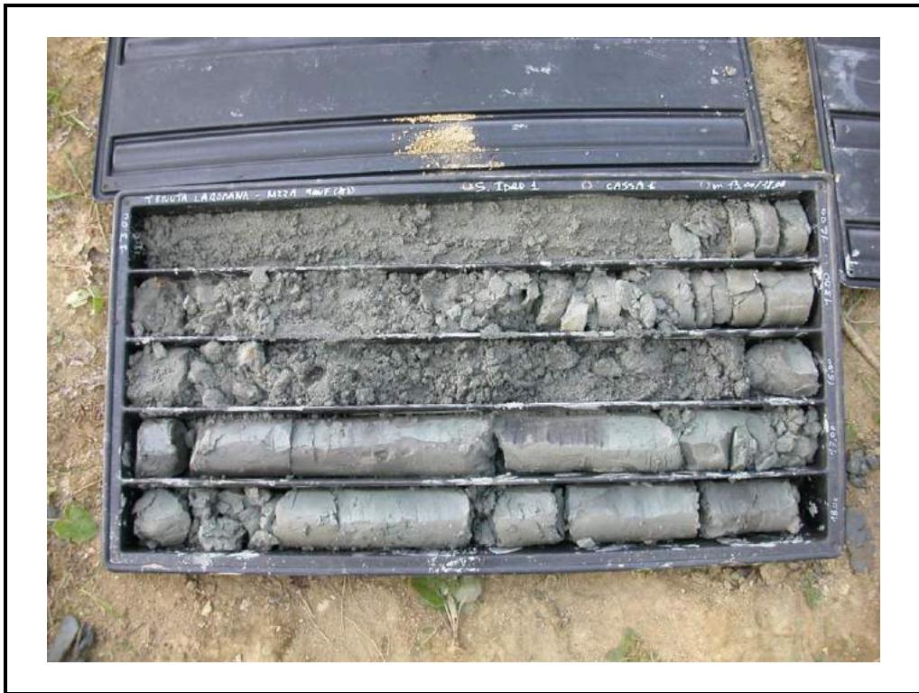
Foto 1: Sondaggio 1 - cassa 1 - da 13.00 m a 18.00 m.
